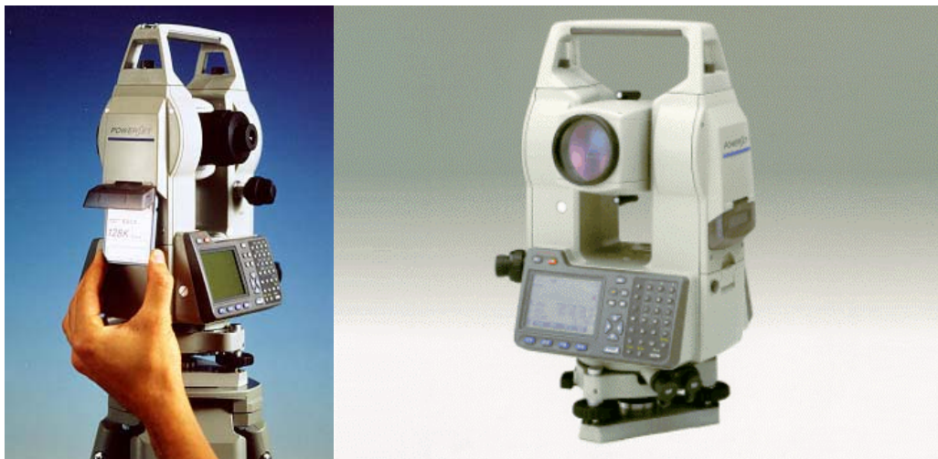
5.2.80. ábra: A Sokkia cég PowerSet elektronikus tahimétere (teljes mérőállomása)
